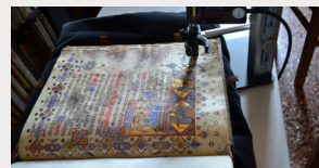
Identificarea și caracterizarea ne-invasivă a pigmentilor dintr-un manuscris miniat din secolul al XIV-lea, utilizând un spectrometru Raman portabil (Biblioteca Națională Marciana, Veneția)
