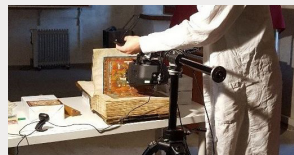
Identificarea și analiza ne-invasivă a pigmentilor dintr-un codex miniat din secolul al XVII-lea, utilizând un spectrometru XRF portabil (Muzeul Mănăstirii Dragomirna, Suceava)
