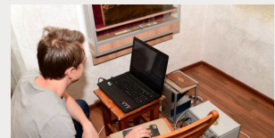
Analiza ne-invasivă a stării de conservare a unei legături antice din piele, utilizând un echipament NMR MOUSE compact (Muzeul Mănăstirii Dragomirna, Suceava)
