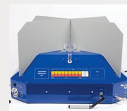
Fig. 1 Echipamente utilizate pentru determinarea ratei de emisie a mirosului din surse difuze de suprafață
