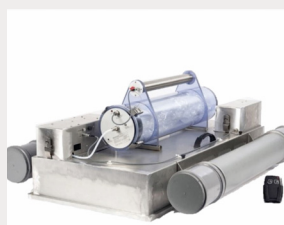
Fig. 1 Echipamente utilizate pentru determinarea ratei de emisie a mirosului din surse difuze de suprafață
