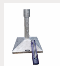
Fig. 1 Echipamente utilizate pentru determinarea ratei de emisie a mirosului din surse difuze de suprafață
