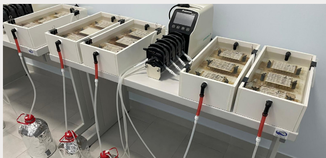
Fig 2. Sisteme lotice artificiale de laborator utilizate pentru studiul modificărilor de biodiversitate cauzate de poluare. Fiecare sistem artificial conține lame de sticlă acoperite cu biofilm de bacterii și este umplut cu apă sterilizată de râu recirculată constant cu o pompă peristaltică.
